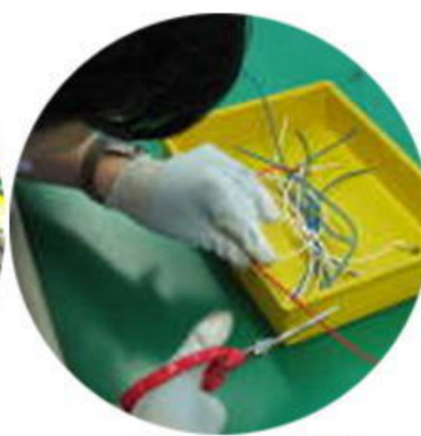
リサイクル作業 自動車用配線の分別作業です
